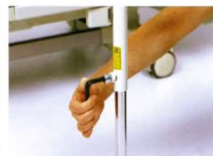
F. 支持パイプの高さを合わせレンチで固定(柵2.3)
